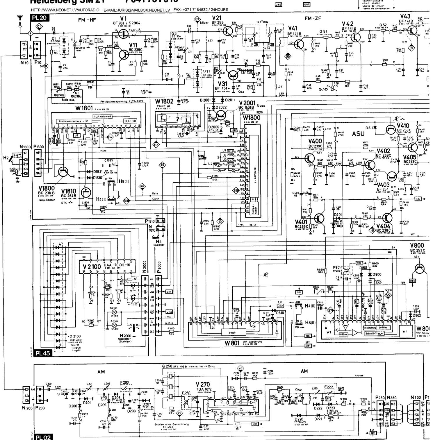
Bereichsschalter H4 ... H7 in Stellung FM gezeichnet; band switches H4 ... H7 drawn in position FM; commutateurs de gammes H4 ... H7 dessinés en position FM; conmutadores de gamas H4 ... H7 dibujados en la posición FM.
