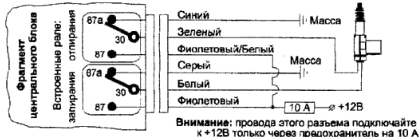
6-контактный разъем для подключения замков дверей Схема подключения дополнительных электроприводов
