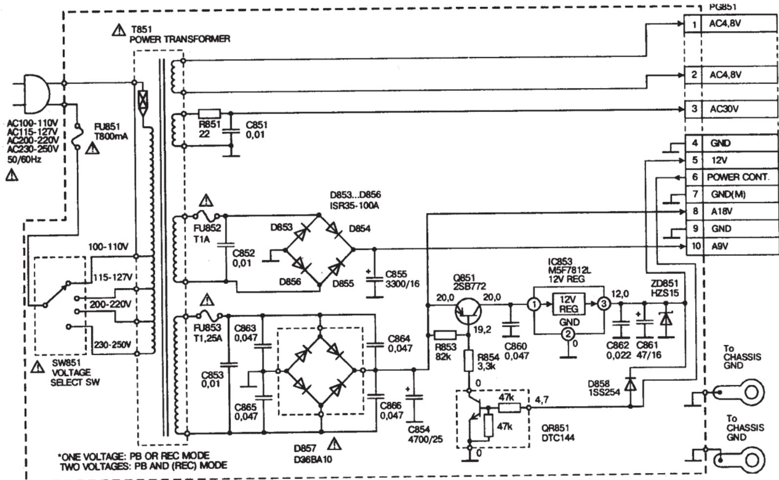
Схема блока питания видеомэгнофона HITACHI VT-M619EM
