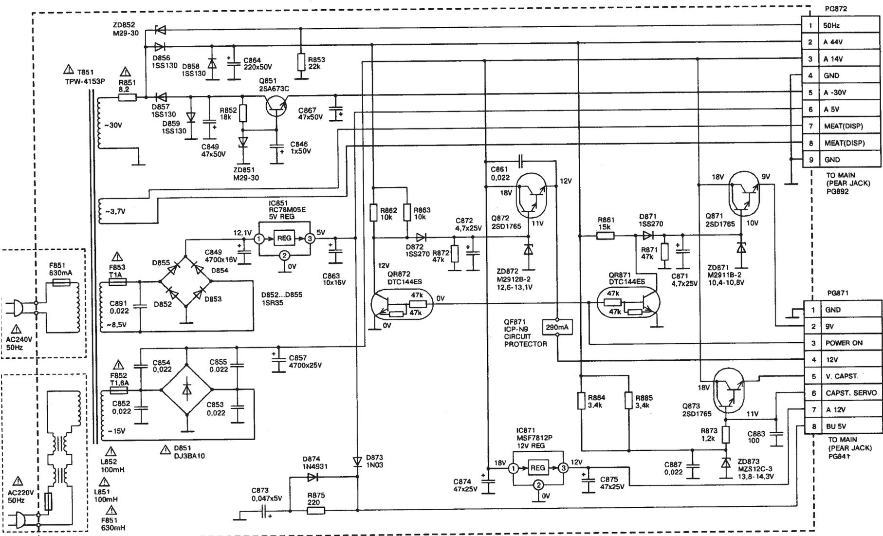
Схема блока питания видеомэагнитофона HITACHI VT-M747GK/AU/UK
