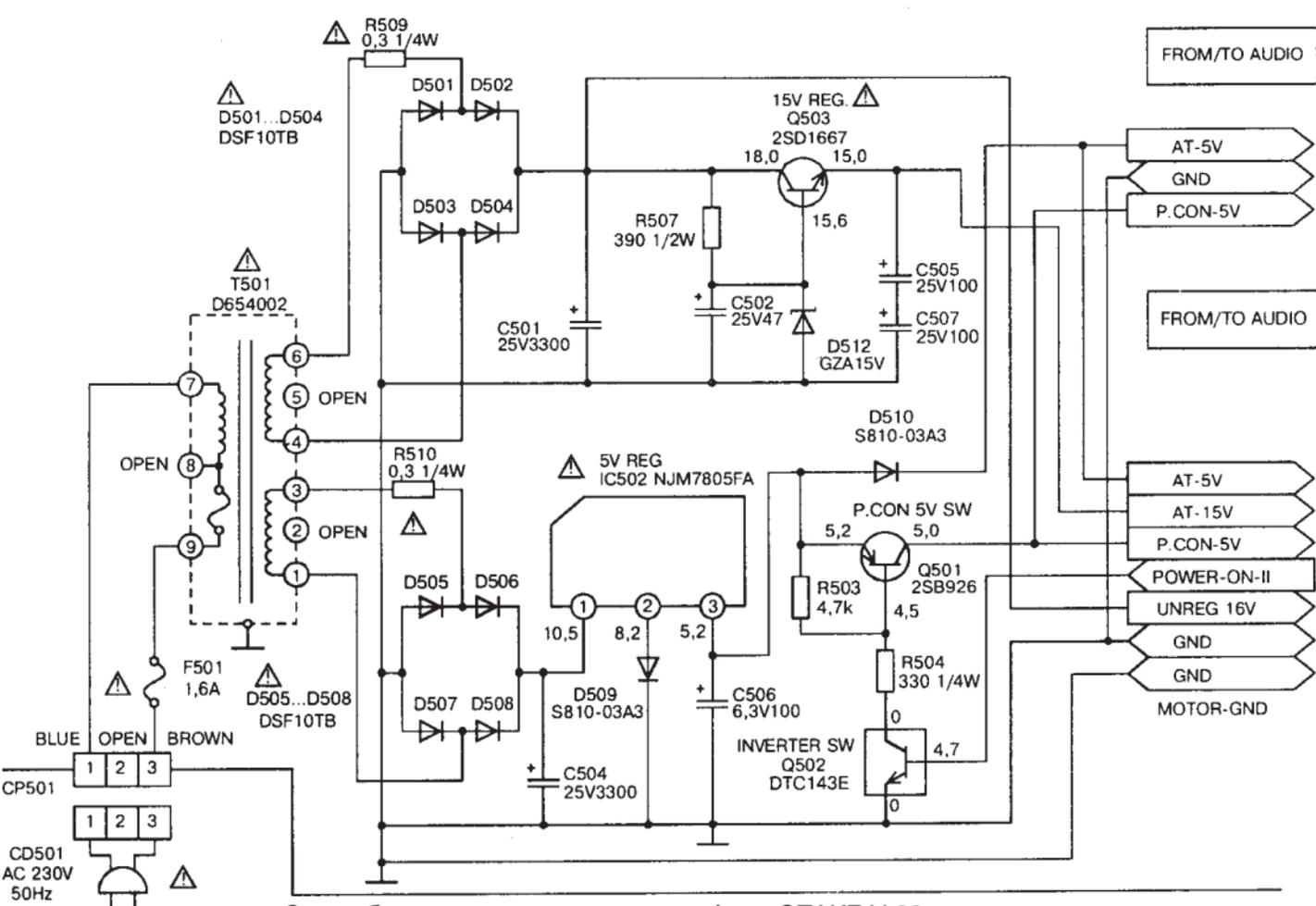
Схема блока питания видеомаягнитофона ОТАКЕ V-33
