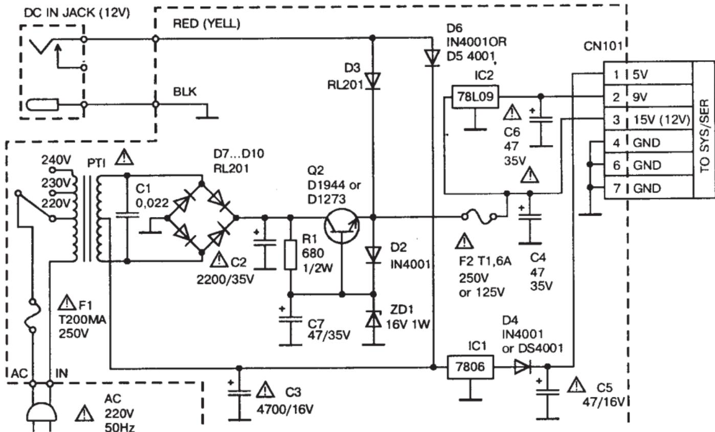
Схема блока питания видеомэгнофона SAMSUNG PK-980R/981R/982R
