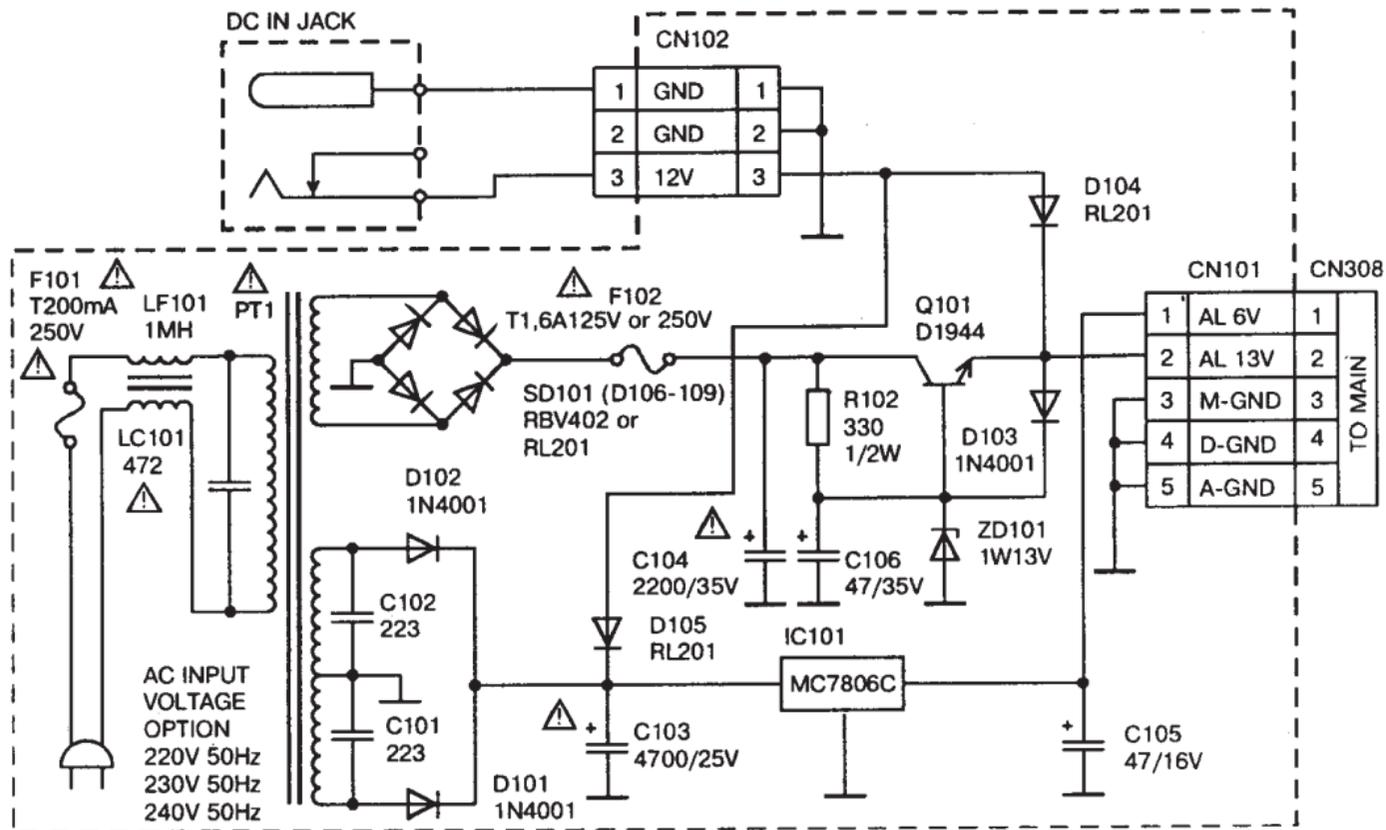
Схема блока питания видеомэагнитофона SAMSUNG PK-990R/991R/992R
